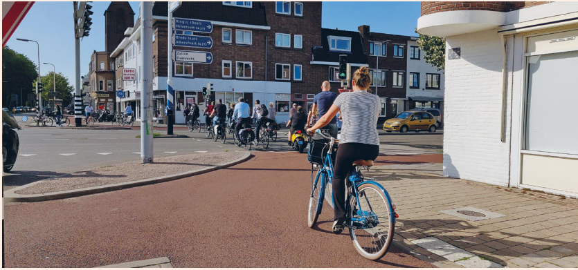
Figur 2: Det beskyttede krydsdesign kombineret med den fleksible signaldrift gør det muligt for cyklister at foretage glatte venstresving i ét træk. Og cyklister, der drejer til højre, behøver slet ikke at vente på et signal.
