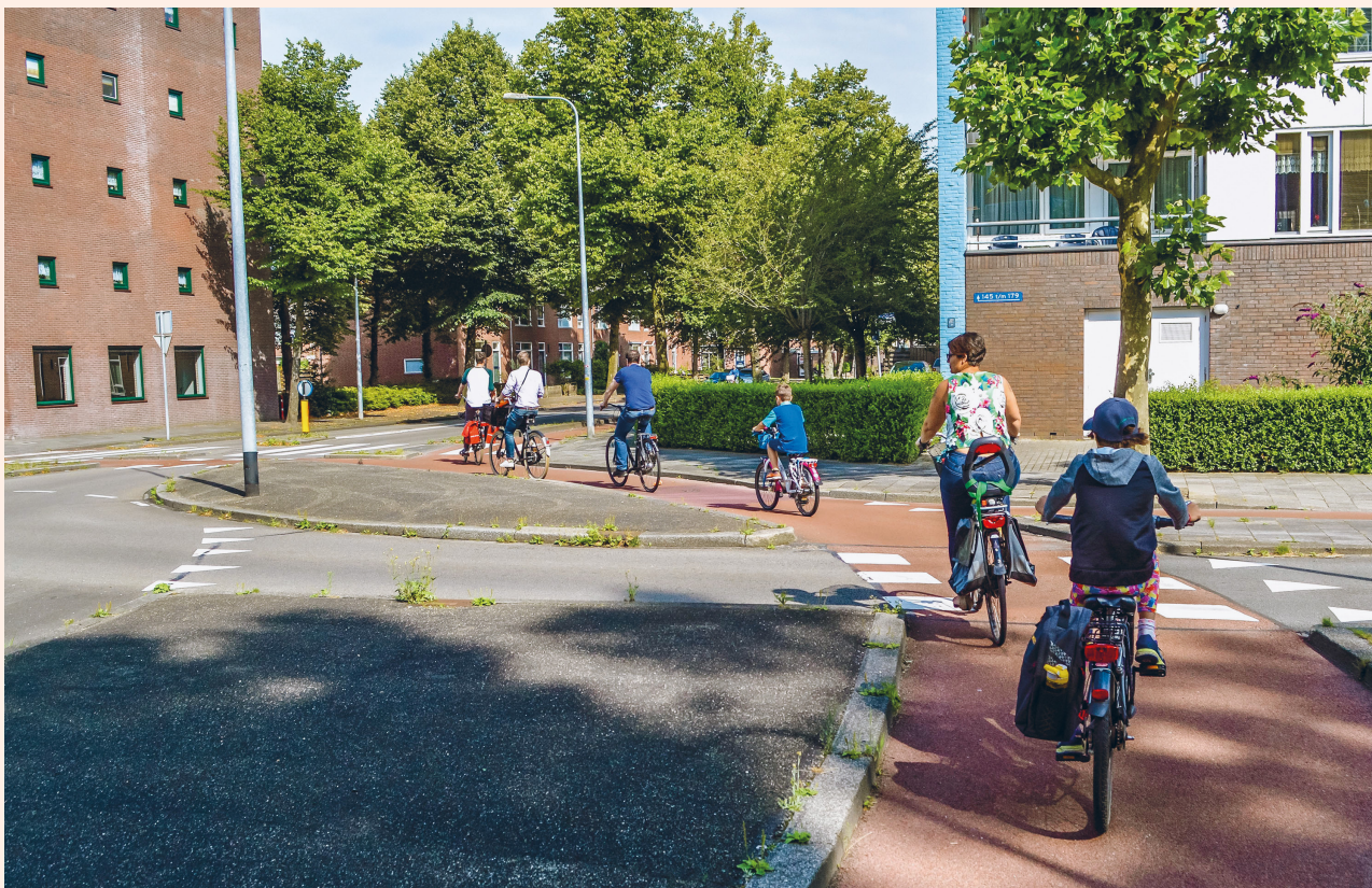
Figur 5: Rundkørsler med adskilte cykelstier kan være et godt alternativ til trafiksignaler, da cyklister slet ikke behøver at stoppe (kredit: Dutch Cycling Embassy).
